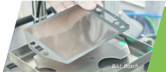
Brennstoffzellen und Stacks der Anlage werden im Bamberger Bosch Werk hergestellt.
