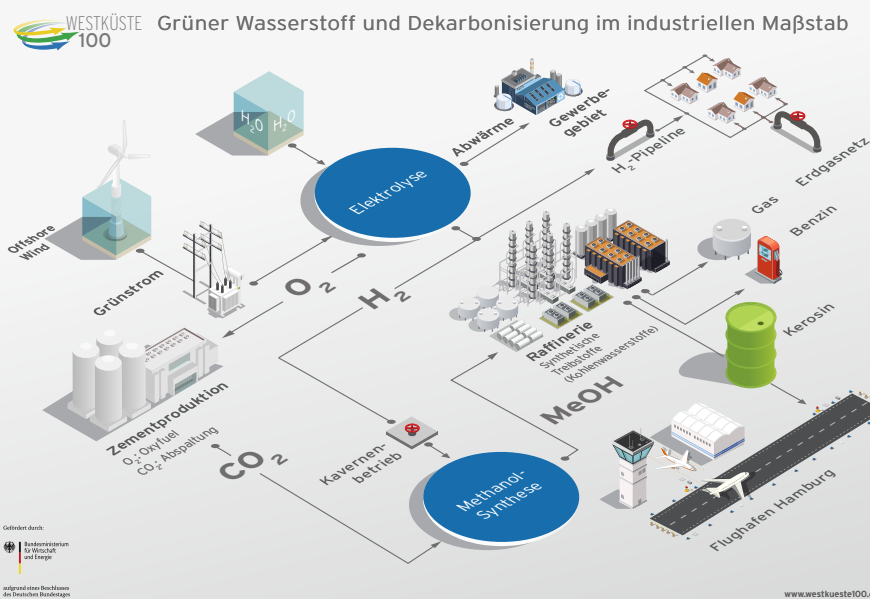
Das Projekt WESTKÜSTE100 erforscht die Nutzung von grünem Wasserstoff im industriellen Maßstab.
